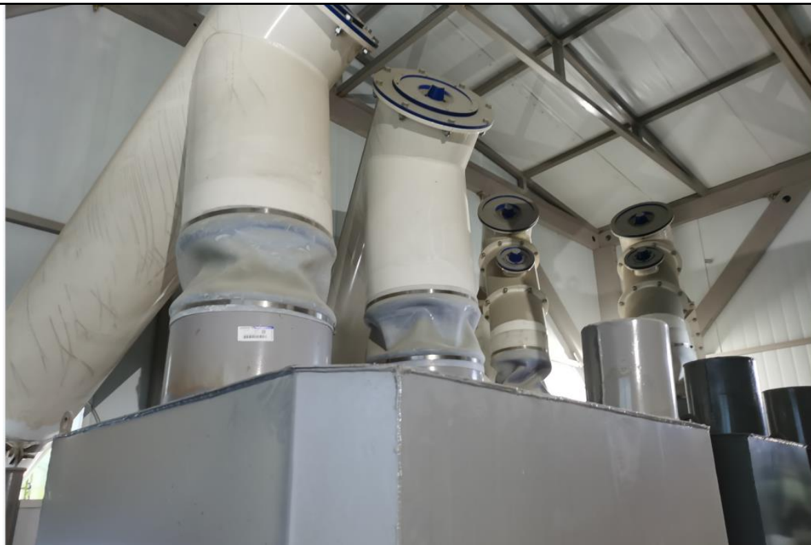
脉冲反吹式布袋除尘器
