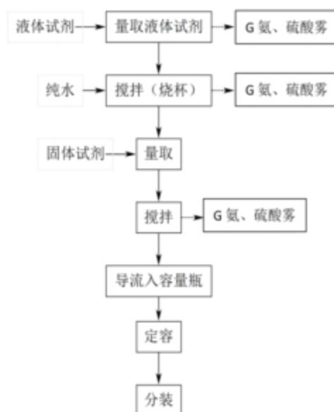
图 2 检测试剂配制生产工艺及产污节点图
