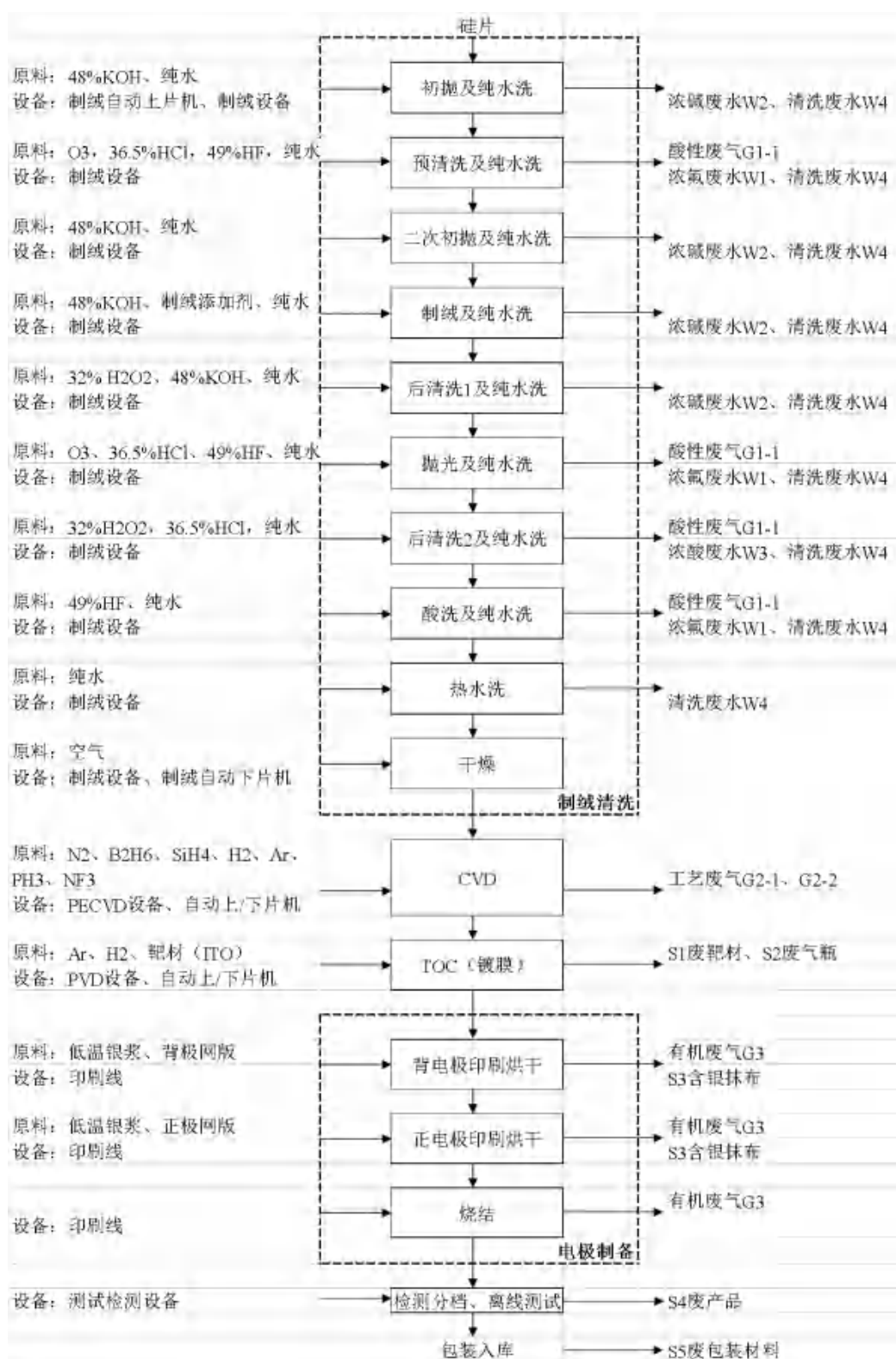
图 2.2.5-3 HJT 工艺流程及产污节点图
