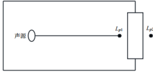
图 14 室内声源等效为室外声源图例
