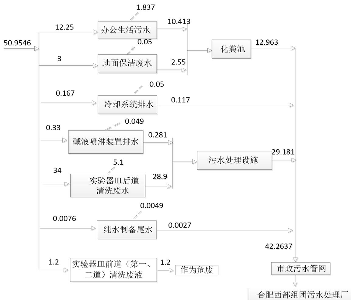
图2-1 项目供、排水平衡图 (单位: t/d)
