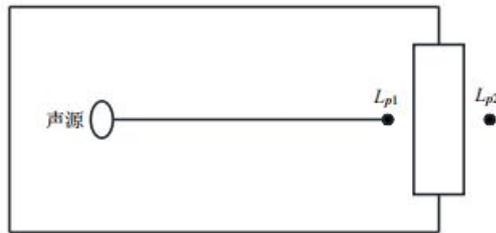
图 12 室内声源等效为室外声源图例
