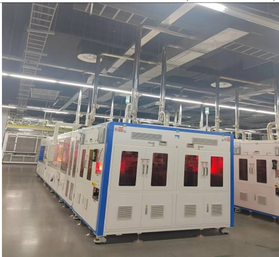
划焊废气收集管道
