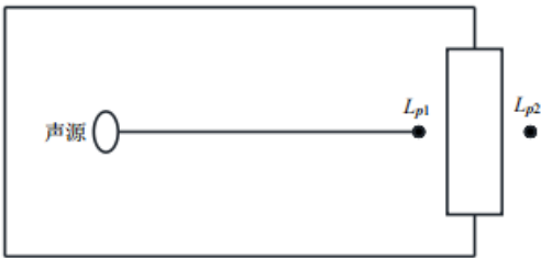
图 6 室内声源等效为室外声源图例
