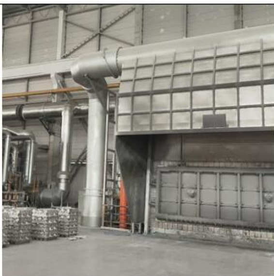
精炼炉密闭保温精炼状态
